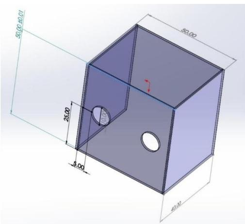
**Figure 1:** The "Aerosol Box" prototype<sup>2,3</sup>
